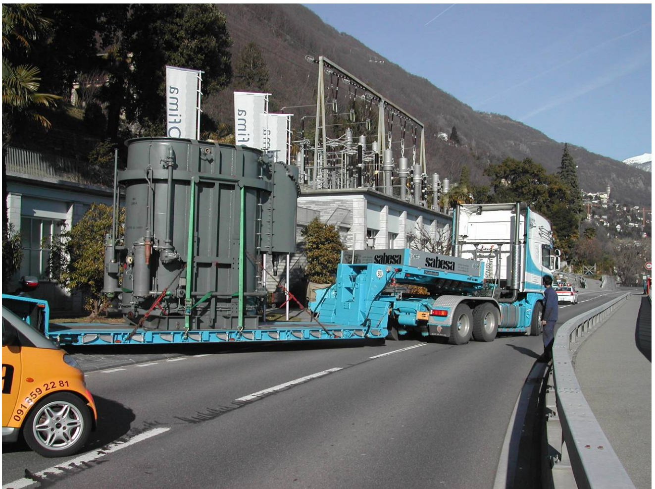
Trasporto di una delle tre fasi del vecchio trafo di Verbano
